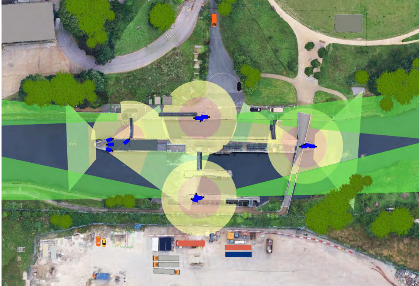
Ein Beispiel aus der Praxis ist eine stark frequentierte Schleusenanlage an einer europäischen Wasserstraße. Dort überwacht ein kombiniertes Videosystem sicherheitsrelevante und betriebliche Abläufe. Thermalkameras detektieren Bewegungen in Ufer- und Zufahrtsbereichen bei Dunkelheit, Nebel oder Regen, während PTZ- und Übersichtskameras gezielte Detail- und Gesamtaufnahmen liefern. Die intelligente Videoanalyse erkennt vordefinierte Ereignisse wie das Eindringen in gesicherte Zonen und löst Warnmeldungen aus.
