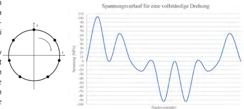
Abbildung 4: Randfaserabstand und Spannungsverlauf über den Nachweispunkt
