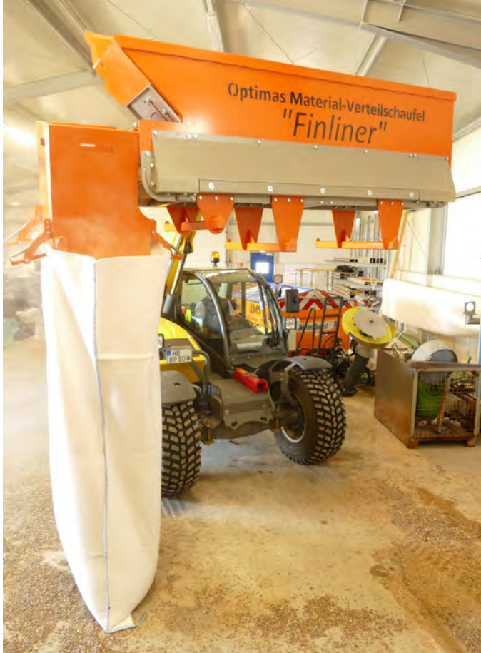
Für den Hochwasserschutz kann der Finliner schnellstens Big Bags befüllen und – wenn nötig – zum Einbauort transportieren.
