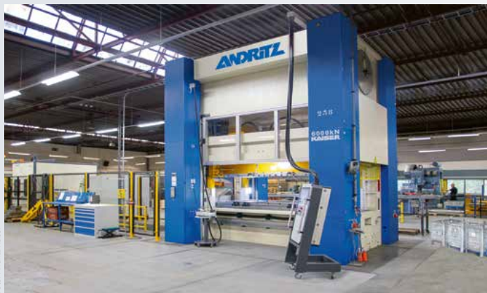
Für einen niederländischen Automotive-Zulieferer entwickelte Andritz Kaiser einen flexiblen Stanzautomaten mit einer Presskraft von 6.000 kN.
