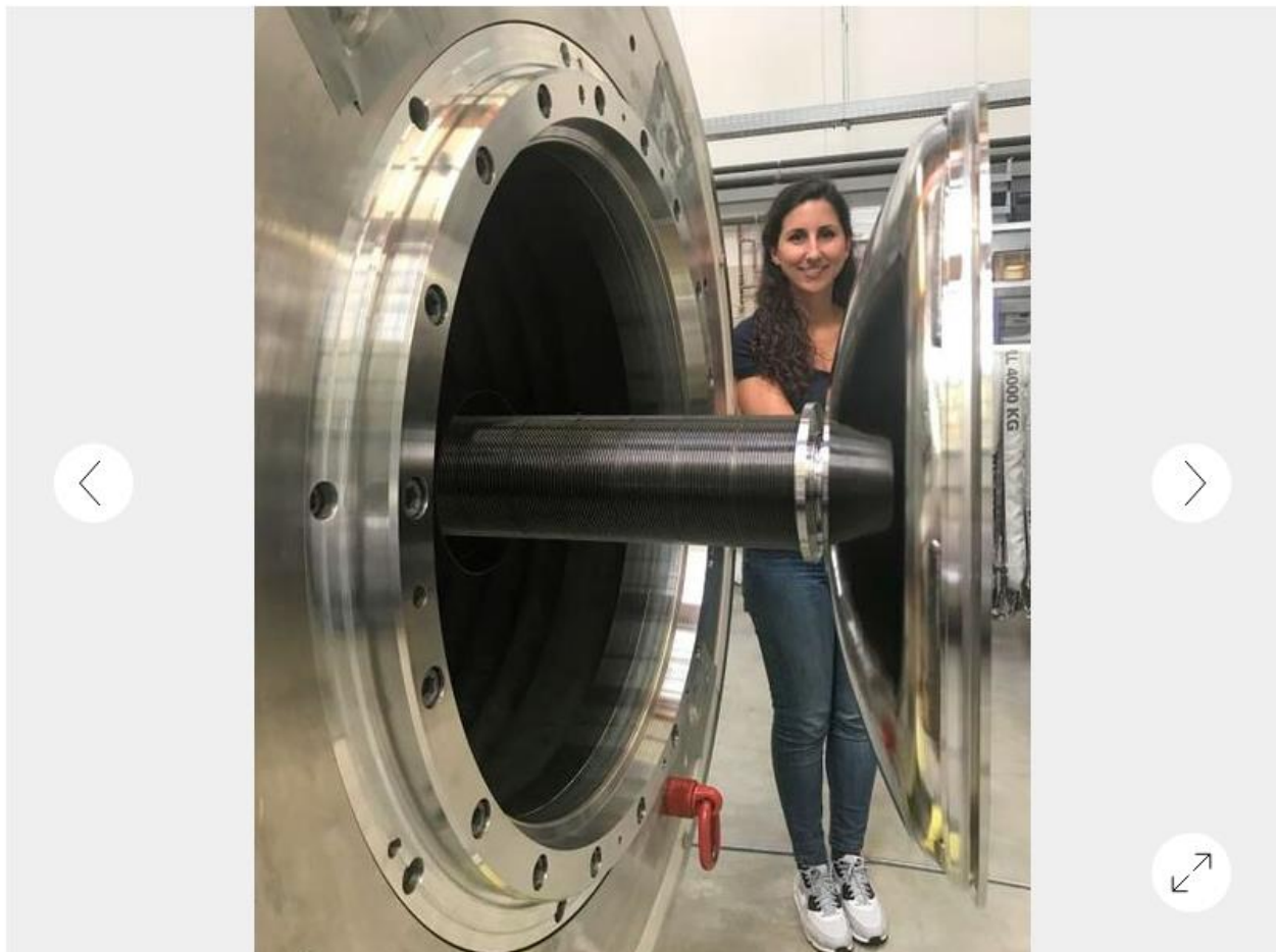
Die immens grossen Einlassventile der Kryopumpe mit fast 1000 mm Durchmesser und minimalem Ventilspiel unter 1 mm verdeutlichen die extremen Anforderungen an die präzise Steuerung. (Bild: Iter)
