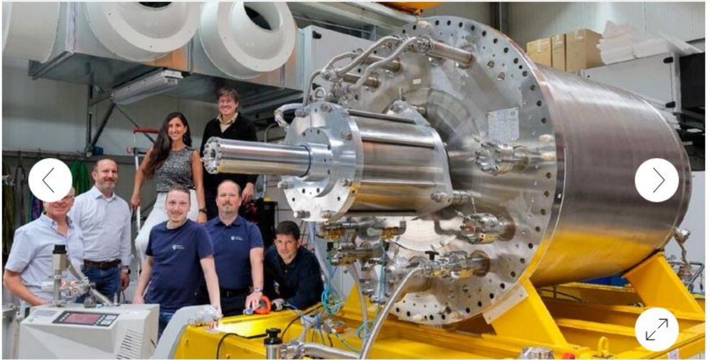
In der Gesamtansicht zeigt die Kryopumpe des Iter-Tokamak die enormen Anforderungen und Herausforderungen für die beteiligten Unternehmen. (Bild: Iter)
