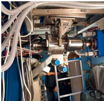
Daher sind heliumführende Leitungen besonders schwierig abzudichten", erläutert Mathias Kraft, Leiter Technik bei Konstandin. "Hinzu kam bei diesem Projekt, dass die Abdichtung trotz eines Drucks von 24 bar sichergestellt sein musste."
