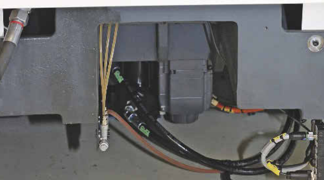
Der Palettenwechsler hebt die im Arbeitsraum befindliche Palette vom Rundtisch ab, sodass diese bearbeitet und anschließend gegen eine andere ausgetauscht werden kann. Bild: Deckel Maho
